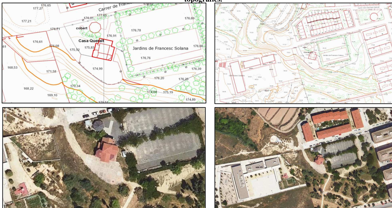
Il·lustració 5. Plànols topogràfics amb Torre Queralt en mig (1:1000; 1:1500); Baix: Ortofoto corresponent als plànols topogràfics.
